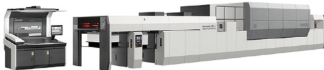
高精細な印刷を実現するNanography®技術を搭載したインプレミアNS40
